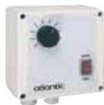
**VEM 3, 6 et 9** : alimentation Mono 230 V. Vitesse variable de 0 à 100 %. Bouton marche-arrêt. Potentiomètre en façade. Réglage mini et maxi à l'intérieur du boîtier - IP 54.
