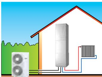
Chauffage haute température & ECS intégrée
